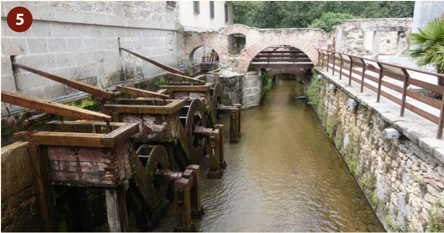
Der Fluss treibt die Mühlräder an, die ihrerseits die Walzprägewerke in Gang setzten. Foto: UK.
