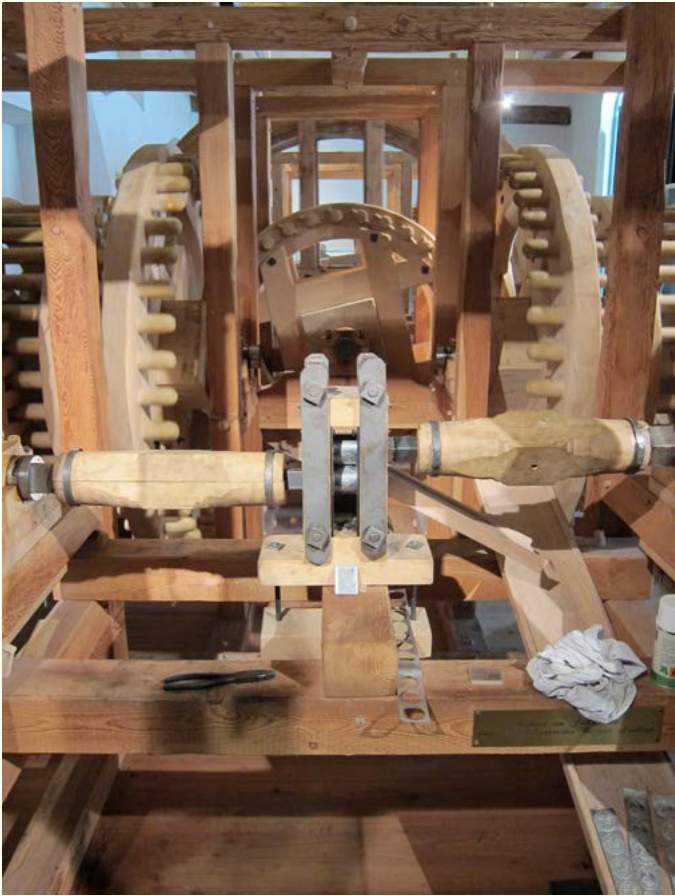
Abb. 3: Die Technik des Walzprägwerks wurde in Zürich erfunden und in Hall perfektioniert. Das hier abgebildete Walzprägwerk ist ein Nachbau, der in Hall besichtigt werden kann. Foto: KW.
